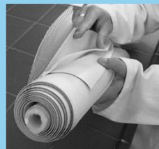
Wickelmodul einer Umkehrosmose mit Membran, Feedspace und Permeatspace
