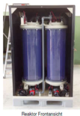
Abbildung 2: Abbildung einer Technikumsanlage zur elektrochemisch unterstützten Regeneration
